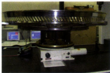
Le top du contrôle tridimensionnel : le laser haute définition (système Métris).
